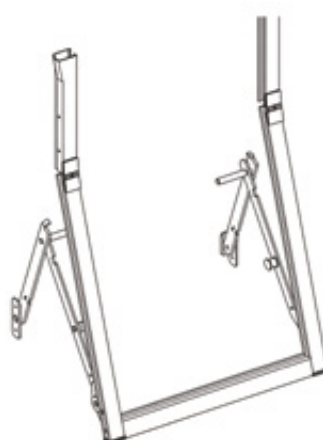
APPSPLLA3 UM ML Apparecchio a sporgere alluminio leva laterale.
