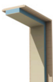
cod. A07-V2 Monoblocco in multistrato fenolico da 21 mm. e pannello XPS con fibrocemento prefinito, per finestre e persiane.
